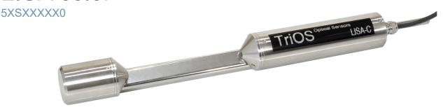
Farbmessung – mit LISA color zuverlässig und preisgünstig möglich. LISA color nutzt zwei unterschiedliche LEDs zur langzeitstabilen Messung des SAK bzw. der Farbe bei unterschiedlichen Wellenlängen. Der zweite Kanal dient dabei der Trübungs-/Untergrundkorrektur. Durch die moderne Geräteplattform, die auch in allen anderen TriOS Photometern verwendet wird, sind optische Weglängen von 50, 100, 150 und 250 mm lieferbar, wodurch sich fast jede Anwendung einfach realisieren lässt.
