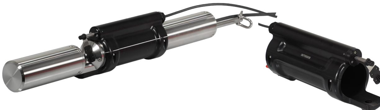
Der TriOS Wischer W55 V2 bietet eine zusätzliche Reinigungsoption für alle TriOS Photometer mit Pfadlängen von 1 mm bis zu 10 mm. Das Wischergehäuse kann in wenigen Schritten am Sensor montiert werden und bietet eine zuverlässige Reinigung der Messfenster. Die neue Magnetsicherung der Achse erlaubt einen schnellen und leichten Wischerblattwechsel, ganz ohne Werkzeug.
