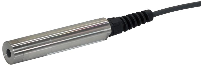
Der Sauerstoff Sensor verwendet die Lumineszenzbasierte optische Messtechnologie und misst präzise und verlässlich. Durch den geringen Wartungsaufwand und wenig Verbrauchsmaterial bietet der Sensor eine unmittelbare Investitionsrentabilität. Es muss lediglich ein zweijährlicher Austausch der Membrankappe erfolgen.
