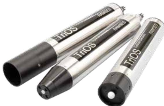
RAMSES Radiometer sind spektralaufösende Radiometer zur Messung von Radianz, Irradianz oder skalarer Irradianz im UV-, VIS- oder UV/VIS-Bereich. Durch geringes Gewicht und BaugröÙe, sowie sehr niedrigem Stromverbrauch sind sie besonders für den portablen oder autonomen Einsatz geeignet. Die Gruppe der RAMSES Radiometer verbindet spektralaufösende Lichtmessung mit einem Höchstmaß an Flexibilität. Das modulare Messsystem re-
