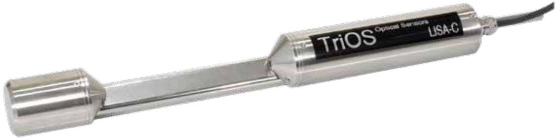
Farbmessung – mit LISA color zuverlässig und preisgünstig möglich. LISA color nutzt zwei unterschiedliche LEDs zur langzeitstabilen Messung des SAK bzw. der Farbe bei unterschiedlichen Wellenlängen. Der zweite Kanal dient dabei der Trübungs-/Untergrundkorrektur. Durch die moderne Geräteplattform, die auch in allen anderen TriOS
