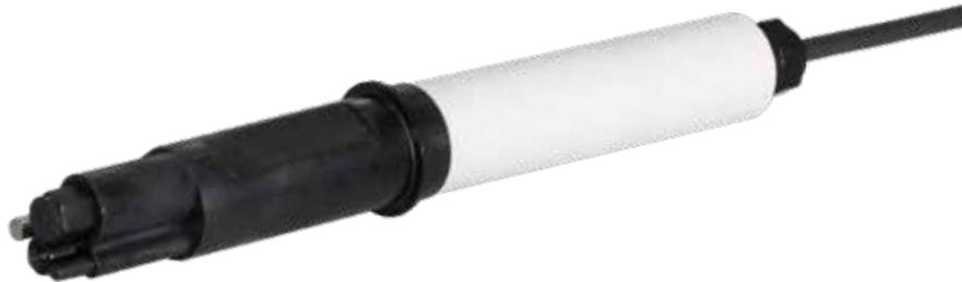
Robuste, digitale Differential-pH-Sonde zum Betrieb an TriBox-Controllern. Das Referenz-System der pH Elektrode ist durch die geschlossene Bauweise vom Messmedium getrennt. Dies schließt Elektrodenvergiftung aus. Eine schmutzunempfindliche Salzbrü-
