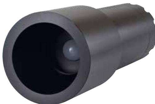
Mit dem FieldCAL-Sekundärstandard lassen sich verlässliche Kalibrier- und Funktionsprüfungen von RAMSES Radiometern im Feld durchführen. Durch das spezielle Design können sowohl Radianz (ARC), als auch Irradianz (ACC) Sensoren überprüft
