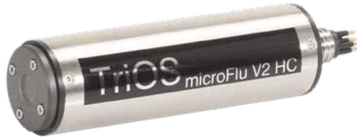
microFlu V2 HC ist eine neue Tauchsonde zur Messung von Öl in Wasser. Das verwendete Messprinzip der UV-Fluoreszenz ist um ein Vielfaches empfindlicher und spezifischer als die herkömmlich verwendete Infrarotstreuung oder als Absorptionsverfahren. Hierdurch ist es möglich, auch geringste Spuren von PAK, z. B. im Trinkwasser, aber auch in Kühlwasserkondensaten zu bestimmen. Das Anwendungsgebiet reicht von der Petrochemie, über Leckagedetektion in Kühl- und Abwasserströmen
