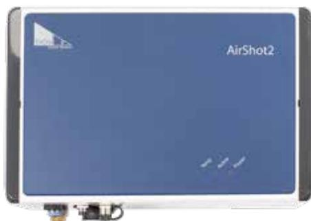
Das kompakte Druckluft-Reinigungssystem AirShot2 arbeitet mit Druckluftimpulsen anstatt eines kontinuierlichen Luftstroms, wodurch die erforderliche Luftmenge erheblich gesenkt wird und ein sehr kompaktes Design möglich ist.
