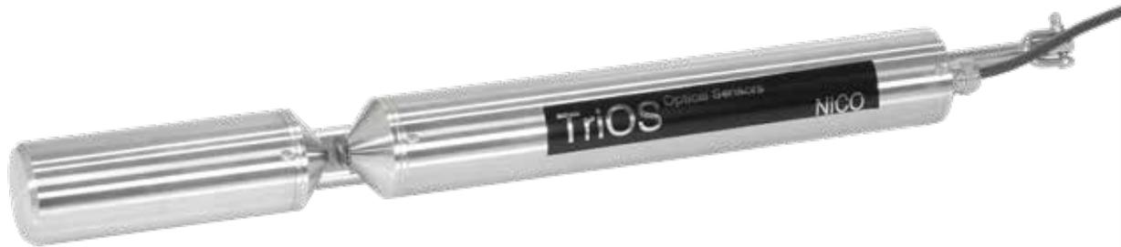
Basierend auf dem innovativen Geräteplattformkonzept von TriOS, auf dem u.a. OPUS, LISA und VIPER beruhen, ist mit NICO ein kostengünstiges UV-Photometer für die Nitratbestimmung verfügbar. Durch die drei Detektionskanäle erfolgt eine präzise optische Nitratbestimmung durch Absorption un-
