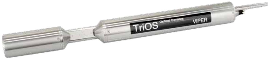
VIPER misst spektral aufgelöste Attenuation im Wellenlängenbereich zwischen 360 nm und 720 nm und erlaubt somit die detaillierte Bestimmung mehrerer Parameter zur gleichen Zeit. Als Lichtquelle dienen 5 ausgewählte und energiesparende LEDs, die stabile Messdaten und eine lange Lebensdauer gewährleisten. VIPER ist in verschiedensten Medien einsetzbar, da es in mehreren Pfadlängen und sowohl in Edelstahl als auch in Titan erhältlich ist.
