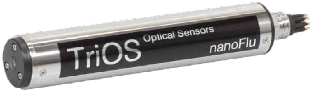
nanoFlu Fluorometer sind günstige, tauchfähige Miniaturfluorometer für hochpräzise und selektive Messung von cdom (colored dissolved organic matter, Gelbstoff), Chlorophyll a, Phycocyanin in Cyanobakterien, Rhodamin oder Fluorescein. Durch die Kombination von niedrigem Stromverbrauch und innovativer Beschichtung der Messfenster als energie- und umweltneutrale Antifoulinglösung kann Langzeitstabilität der Messungen gewährleistet werden. Die Geräte sind in vielfältigen Anwendungen zur
