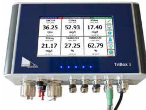
TriBox3 ist ein Mess- und Regelsystem für alle TriOS-Sensoren. Das Gerät bietet 4 Sensorkanäle mit wählbarer RS-232- oder RS-485-Schnittstelle. Neben Modbus-RTU sind verschiedene andere Protokolle verfügbar. Ein eingebautes Ventil ermöglicht die Verwendung einer Druckluftreinigung für die Sensoren. Daneben bietet die TriBox3 diverse Schnittstellen u.a. eine IEEE 802.3 Ethernet Schnittstelle, eine IEEE 802.11 b/g/n Schnittstelle, einen USB-Anschluss und 6
