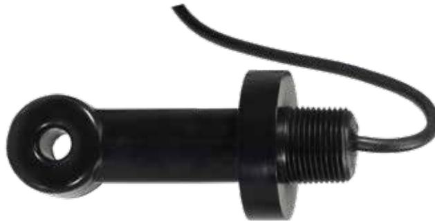
Der induktive Leitfähigkeitssensor besitzt 2 Ringkernspulen, welche in einem Kunststoffgehäuse untergebracht sind und daher nicht mit der umgebenden Lösung in Berührung kommen. Aus diesem Grund ist es physikalisch unmöglich, dass die Sensoroberfläche verschmutzt, beschichtet oder verunreinigt wird.
