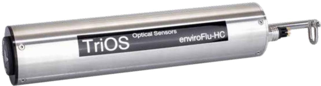
enviroFlu-HC ist eine neue Generation von Tauchsonden zur Messung von Öl-in-Wasser. Das verwendete Messprinzip der UV-Fluoreszenz ist um ein Vielfaches empfindlicher als die herkömmlich verwendete Infrarotstreuung oder Absorptionsverfahren. Hierdurch ist es möglich, auch geringste Spuren von PAKs, z. B. im Trinkwasser, aber auch in Kühlwasserkondensaten zu bestimmen. Das Anwendungsgebiet reicht von
