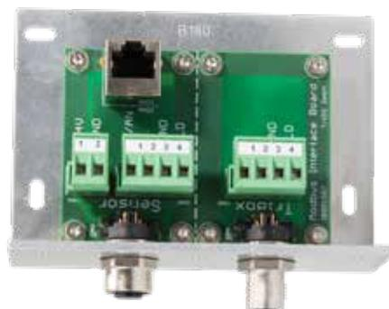
Das Modbus Interface führt die Sensorschnittstellen der TriBox3, TriBox Mini oder der TriOS G2-Sensoren auf Steckverbinder und bietet somit eine einfache und flexible Anschlussmöglichkeit. Der Anschluss an die TriBox erfolgt über eine Standard M12-Verlängerung. TriOS G2-Sensoren mit M12-Steckverbinder können direkt angeschlossen werden. Für den
