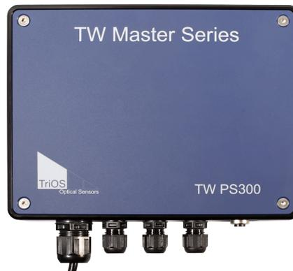
Die TW PS300 ist ein Netzgerät zum Anschluss von Sensoren der TW Master Serie. Das Gerät verfügt über ein Schnittstellenmodul mit Funktionen wie Relaisausgang und analogem 4-20 mA Signalausgang.
