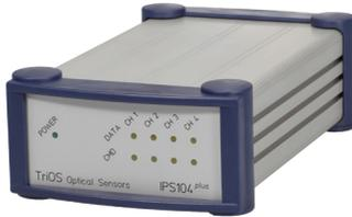
Die CMD-LEDs zeigen hier nicht den Anschluss des PCs an, sondern den Betrieb der bestückten Schnittstellen für die Sensoren an (z.B. leuchtet die CMD-LED von Ch 4 nicht, wenn Sie eine 2- oder 3-Kanal-Version betreiben). Blinkende CMD-LEDs zeigen an, dass von der Steuereinheit (z.B. PC) Befehle an die Sensoren gesendet werden.
