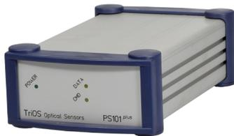
Die Frontplatte des Geräts enthält 3 LEDs. Die grüne zeigt an, dass das System mit Strom versorgt wird. Die beiden anderen gelben LEDs zeigen den Status der RS-232-Leitungen an. Die CMD-LED überwacht die PC-Verbindung und Aktivitäten, die DATA-LED überwacht die angeschlossene Sensorleitung. Beide zeigen die folgende Funktionalität an:
