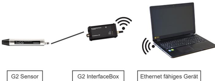
Die TriOS G2 InterfaceBox WiFi übersetzt den 8-Pin-M12 Sensorstecker auf die handelsüblichen Anschlüsse für die Spannungsversorgung (2,1mm Hohlstecker) sowie für den drahtlosen Netzwerkzugang (WiFi).
