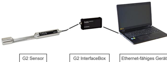
Die TriOS G2 InterfaceBox übersetzt den 8Pin-M12 Sensorstecker auf die handelsüblichen Anschlüsse für die Spannungsversorgung (2,1mm Hohlstecker) sowie für den Netzwerkzugang (RJ45 Buchse).
