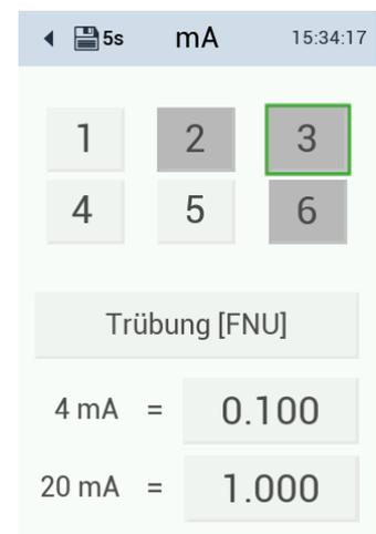
Grün umrandet ist der Analogausgang, der konfiguriert wird. Grau unterlegt sind belegte Ausgänge. Von einem anderen Gerät belegte Ausgänge müssen erst freigegeben werden, bevor sie erneut belegt werden können.
