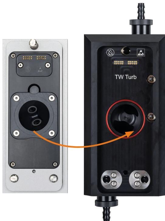
Der Sensor misst nach dem nephelometrischen Prinzip der 90°-Infrarotstreuung. Anhand der vom Detektor gemessenen Streuintensität, die im 90°-Winkel zur Lichtquelle angeordnet ist, kann die Trübung einer Flüssigkeit genau bestimmt werden.
