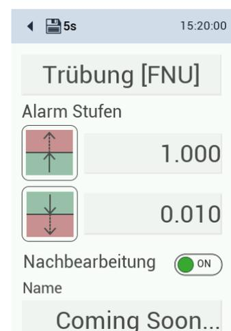
In der oberen Schaltfläche kann die Einheit zwischen FNU und NTU gewechselt werden.
