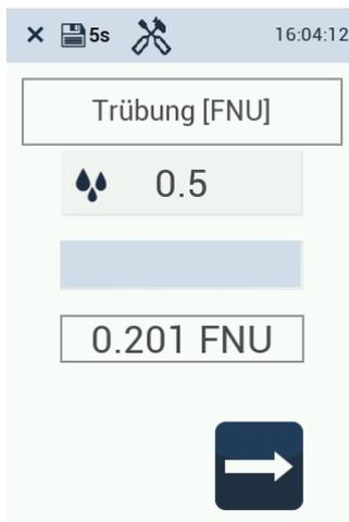
Wenn die Kalibrierung abgeschlossen ist, wird der Pfeil unten rechts im Display aktiviert. Klicken Sie auf diese Schaltfläche, um die Kalibrierung zu überprüfen.
