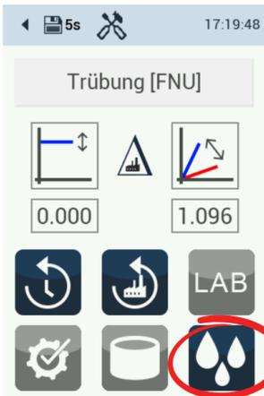
Nach dem Einstellen des Wartungsmodus wird der Vorgang mit dem Drücken der markierten Taste (Kalibrieren) gestartet.
