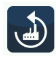
Diese Taste setzt auf die Werkskalibrierung zurück. Das Zurücksetzen ist mit einem Haken zu bestätigen.
