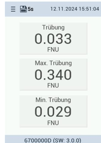
Die Anzeige zeigt die Seriennummer und die aktuelle Softwareversion unten im Display. Ist die Nachbearbeitung aktiviert (Postprocessing), erscheint das Symbol dazu oben rechts im Messfeld.
