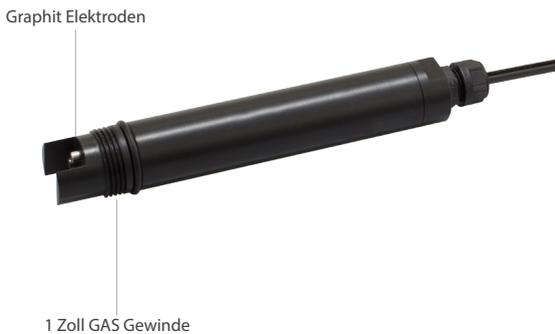
Der konduktive Messsensor verfügt über zwei einander gegenüberliegenden Graphitelektroden. An den Elektroden wird eine Spannung angelegt, so dass im Messmedium ein Strom erzeugt wird.
