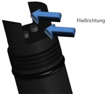
Beim Einbau des Sensors muss sichergestellt werden, dass der Sensor zu jeder Zeit unter Wasser bleibt und von eventueller Strömung nicht bewegt wird, da ansonsten unplausible Messwerte entstehen könnten.
