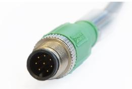
Verbinden Sie den Stecker mit einem der mitgelieferten TriOS-Kabel (2 m). Es werden zusätzliche Kabellängen von 0,3 m, 2 m, 5 m, 10 m, 25 m angeboten. Stecken Sie das Steckerende des Kabels auf den Anschlussstecker des Sensors, indem Sie die Pins an den Steckplätzen des Kabels ausrichten. Drehen Sie im nächsten Schritt die Verriegelungshülse im Uhrzeigersinn, um das Steckerende zu befestigen.
