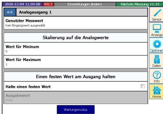
Im unteren Bereich kann für Testzwecke das Halten eines festen Wertes für die jeweilige Schnittstelle aktiviert werden.
