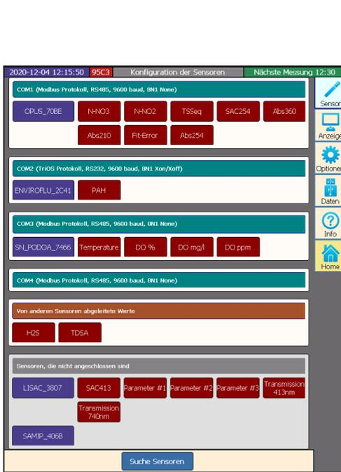
Dies sind die derzeit angeschlossenen Sensoren, welche zur Messung bereit stehen.
