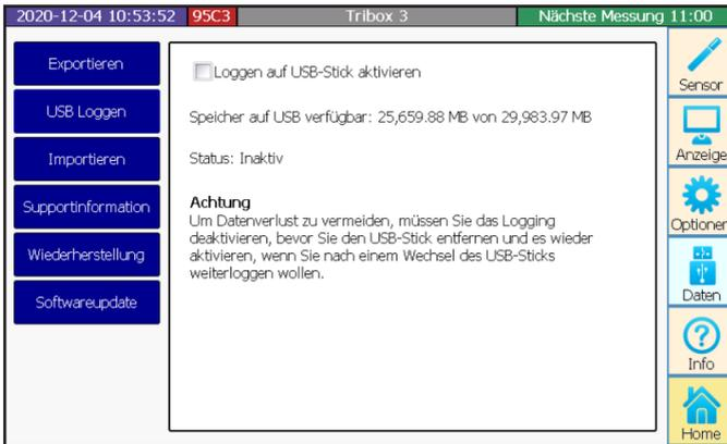
Die Funktion „USB-Loggen“ ist nur bei eingestecktem Datenträger aktiv. Vor dem Entfernen sollte man dieses Fenster immer deaktivieren um Datenverlust zu vermeiden. Passende USB-Sticks die die IP-Schutzklasse nicht beeinflussen sind bei TriOS als Zubehör erhältlich.
