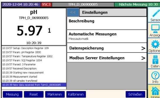
In diesem Bildschirm ist links oben der aktuelle Messwert und darunter das Log Protokoll zum Sensor sichtbar. Auf der rechten Seite kann eine Beschreibung des Messstandorts eingegeben und automatisches Messen aktiviert bzw. deaktiviert werden. Einige Sensoren verfügen hier über die Möglichkeit "Schnellstmöglich", wobei der Sensor so oft wie möglich eine Messung auslöst.
