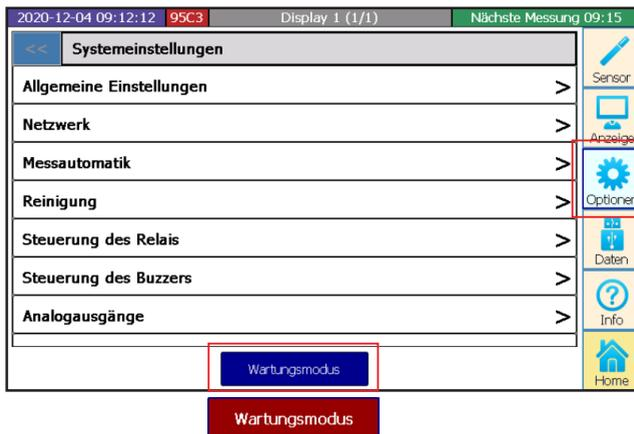
Wenn der Wartungsmodus aktiviert ist, werden Relais, Ventil und Buzzer deaktiviert. Zudem wird die Messautomatik ausgesetzt.
