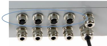
Die TriBox3 ist mit vier female M12-Sensorschnittstellen ausgestattet. Die Schnittstellen unterstützen RS-232 und RS-485 und können auf das serielle TriOS-Protokoll, Modbus RTU und weitere spezielle Protokolle eingestellt werden.
