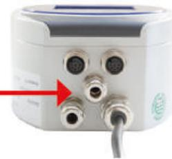
3. Verbinden Sie die Adern braun und weiß der Anschlussleitung mit dem Steckverbinder CON2, Pin 3 (Bezeichnung VOUT+) und die Adern blau und schwarz mit dem Steckverbinder CON2, Pin 4 (Bezeichnung VOUT-), wie in der nachstehenden Tabelle beschrieben. Die Adernpaare sind bereits zusammen in einer Aderenhülse verbunden. Ziehen Sie die Schrauben fest an.
