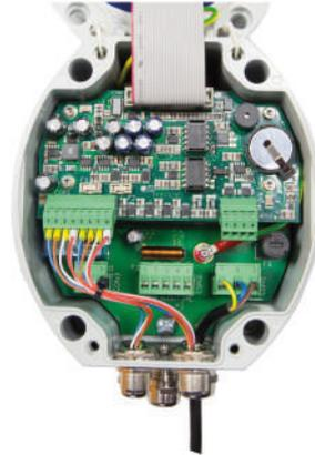
2. Führen Sie nun die Anschlussleitung der VentilBox V2 durch die Kabeldurchführung in der TriBox mini und sichern danach die Kabelverschraubung.
