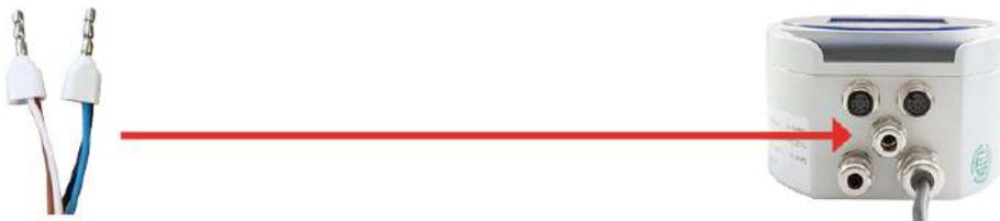
3. Schließen Sie den blau-schwarzen Draht des AirShot2-Kabels an Pin 4 (VOUT-) des CON2-Steckers an und den braun-weißen Draht an Pin 3 (VOUT+), wie in der Tabelle unten beschrieben. Stellen Sie sicher, dass die Schraubkontakte festgezogen sind.
