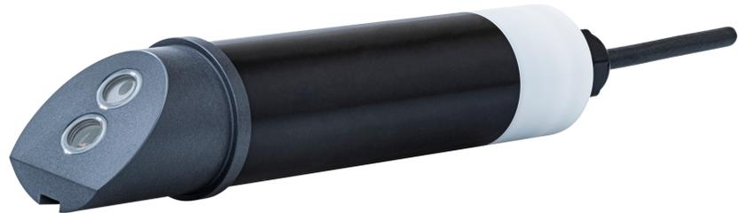
Der TTurb ist ein digitaler Sensor für die optische Trübungsmessung nach der 90° IR-Streulichtmethode. Je nach Sensorausführung kann er sowohl in reinem Wasser bis zu 100 FNU als auch in Rohwasser, Abwasser und Prozesswasser bis zu 1000 FNU eingesetzt werden. TTurb ist sowohl mit verschiedenen Kabellängen (10 m, 2 m oder 0.5 m) als auch in verschiedenen Ausführungen zu erhalten.
