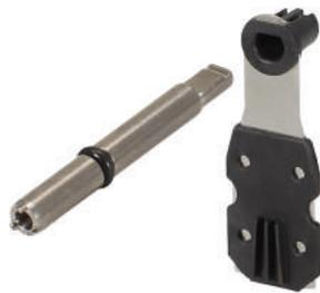
2. Den O-Ring auf der Achse etwas einfetten und die Achse in das Wischergehäuse stecken. Die Achsnut wird magnetisch angezogen und muss bis zum Anschlag eingeführt und ggf. etwas gedreht werden, bis die korrekte Position einrastet.
