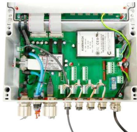
2. Legen Sie das Wischerkabel (Steuerleitung M8) durch die Kabelführung der TriBox3 und stellen Sie die Kabelführung an dem breiteren Teil des Kabels fest.
