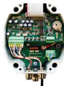
2. Legen Sie das Wischerkabel durch die Kabelführung der TriBox mini und stellen Sie die Kabelführung fest.
