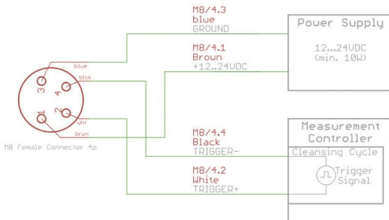
**Option 2:** M8-Anschlussleitung mit offenen Enden (im Lieferumfang), Reinigungssteuerung (Trigger) und Spannungsversorgung sind separat angeschlossen
