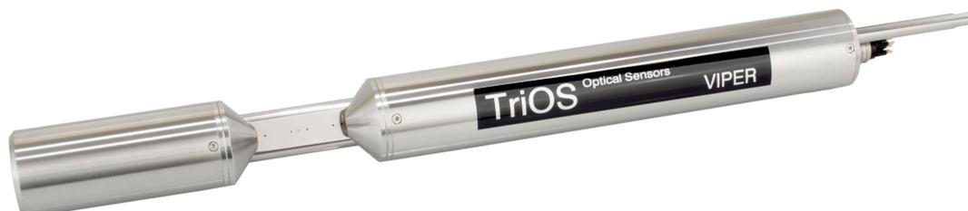
VIPER misst die spektral aufgelöste Attenuation (Lichtabschwächung) im Wellenlängenbereich von 360 bis 720 nm und ermöglicht dadurch die gleichzeitige, präzise Bestimmung mehrerer Parameter. Fünf ausgewählte, energiesparende LEDs dienen als Lichtquelle und sorgen für stabile Messergebnisse und lange Lebensdauer.
