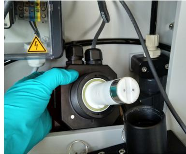
Nachdem der Durchflusssensor gereinigt wurde, sollte er wieder fest in den EGC Water Analyzer eingeschraubt werden. Hierzu schieben Sie den Sensor wieder in die vorgesehene Halterung zurück und ziehen die Überwurfmutter durch Drehen fest an.
