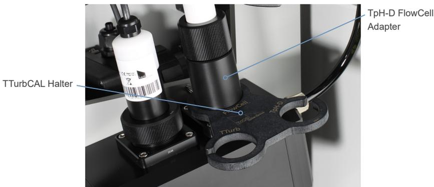
Messaufbau vor Überprüfung des Sensors
