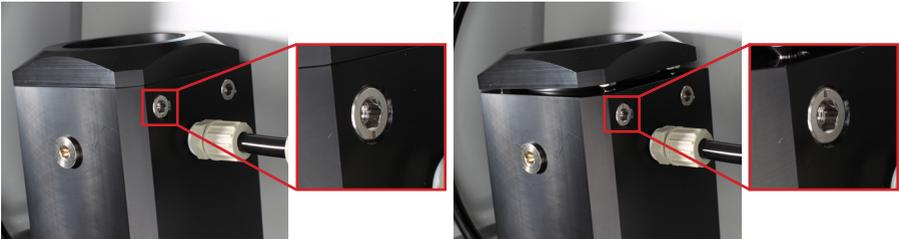
2. Die Halterklemme mit einem 6 mm Inbusschlüssel entfernen. Um die Kabel der Sensoren zu fixieren, können Sie die Plastiksellen am vorderen und hinteren Panel nutzen.
