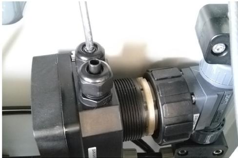
Der Sensor kann nun mit einem Tuch, das leicht mit Wasser befeuchtet ist, gereinigt werden. Bei groben Verschmutzungen wird handelsübliches Spülmittel empfohlen.
