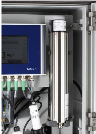
Das DryCAL-Set kann nur zusammen mit dem jeweils zugeordneten enviroFlu HC 500, bzw. enviroFlu HC 5000, verwendet werden. Beide Produkte wurden im Labor des Herstellers genau aufeinander abgestimmt, sodass die Kontrolle des Messwertes ausschließlich in der Kombination mit dem entsprechenden enviroFlu gewährleistet ist. Die Seriennummer des zugehörigen Sensors ist auf dem Typenschild aufgedruckt. Mit DryCAL-0 wird der Nullwert (Offset), mit DryCAL-1 die Steigung (Scaling) bestimmt.
