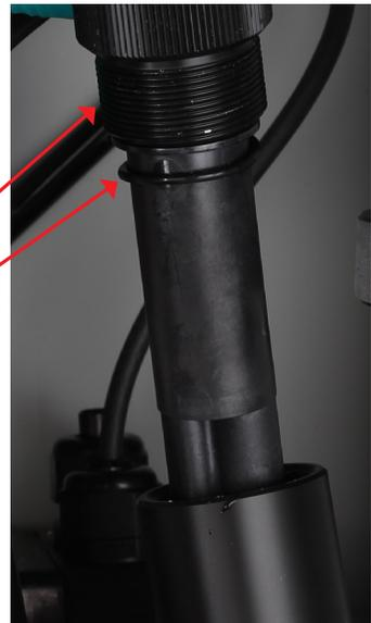
3. Sobald der TpH-D auf der FlowCell montiert ist, Andruckring über das Kabel vom Stecker her kommend auf den Sensor bringen und diesen an der FlowCell fixieren.
