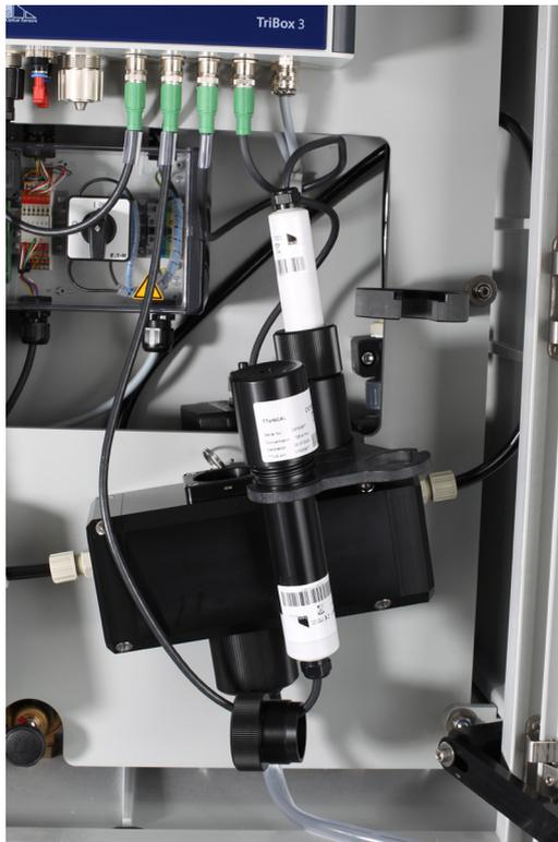
10. Folgen Sie den Anweisungen des Kalibrierwizards auf Ihrer TriBox3 um die Skalierung des Sensors anzupassen. Den passenden Wert finden Sie aufgedruckt auf dem TTurbCAL.
