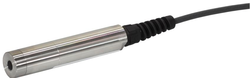
Der Sauerstoffsensor nutzt eine lumineszenzbasierte, optische Messtechnologie und liefert präzise sowie zuverlässige Messergebnisse. Dank seines geringen Wartungsaufwands und des sparsamen Verbrauchs an Materialien bietet der Sensor eine schnelle Investitionsrentabilität – lediglich ein Austausch der Membran-Kappe alle zwei Jahre ist erforderlich.
