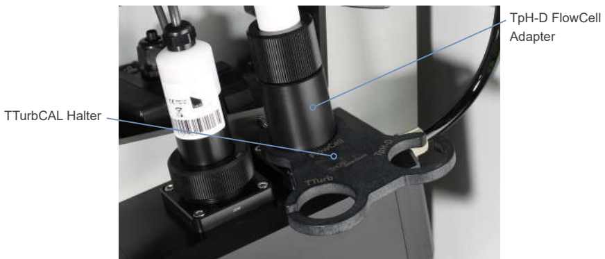
Messaufbau vor Überprüfung des Sensors
